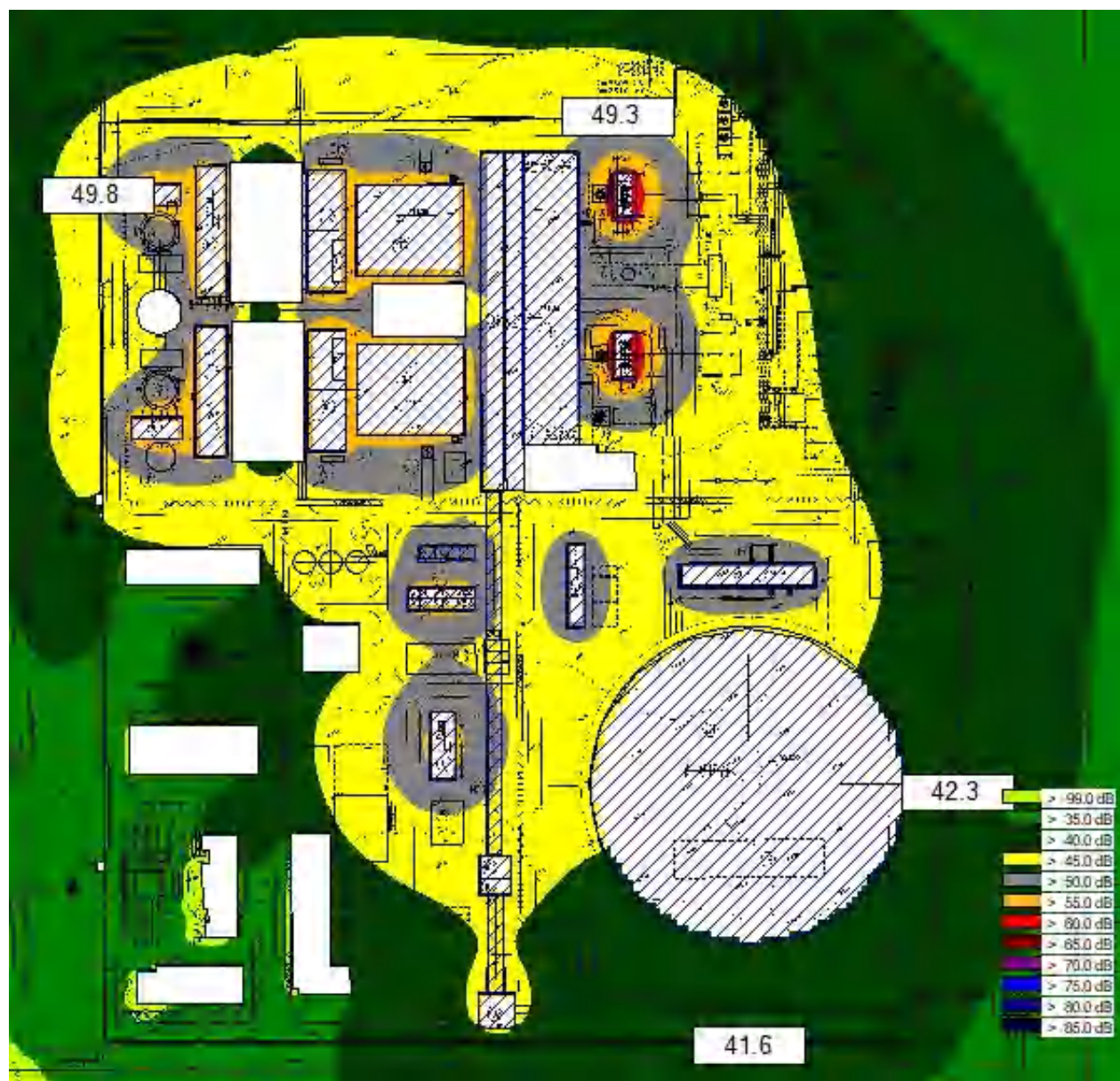
图 5.4-1 正常工况下本工程声源设备噪声预测等效 A 声级图
